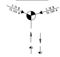
Neigungsbrechpunkt mit Angabe von Gefälle und Steigung in Prozent, Länge der Gefälle- bzw. Steigungstrecke, Halbmesser, Tangentlänge, Scheitelabstand, Station und Höhe Tangentschnittpunkt
