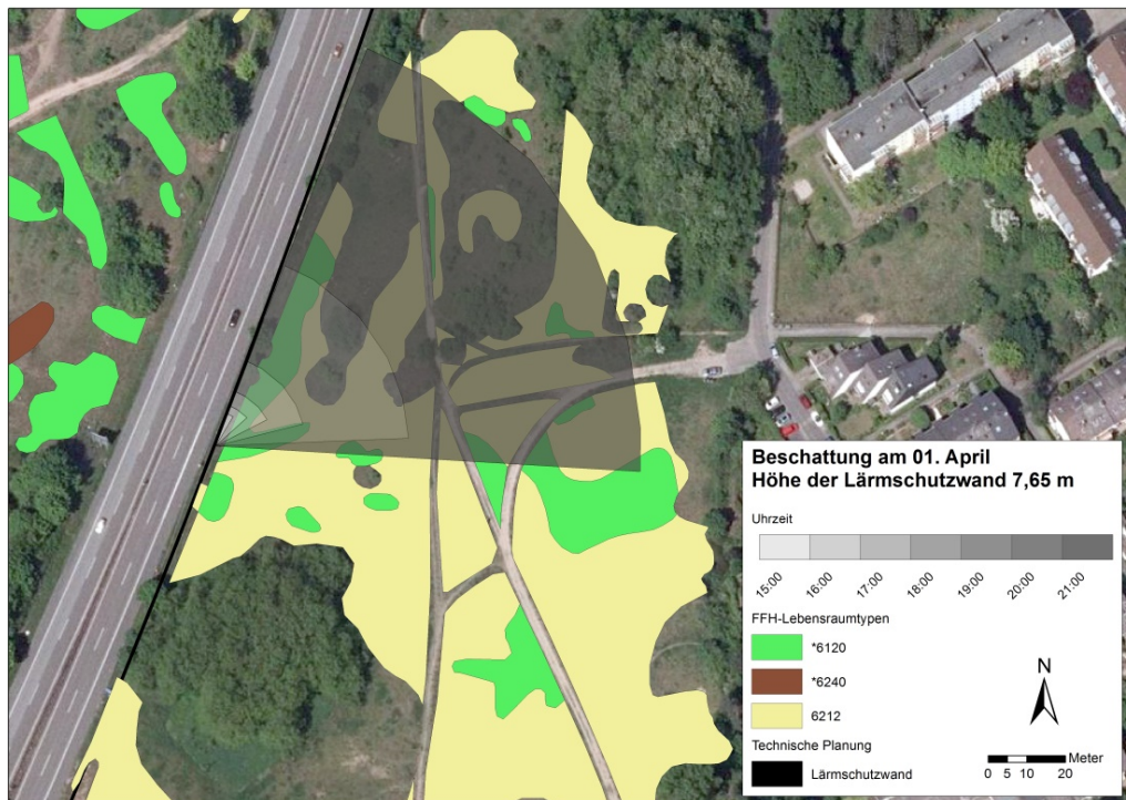
Abb. 5-5: Schattenentwicklung am 01. April bei einer Lärmschutzwand mit 8 m
