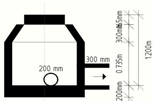
Versatz wird als Differenz zwischen Rohr- und Schachtsohle berechnet
