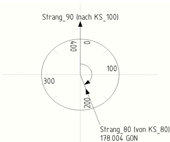
Winkel werden als Differenzwinkel zwischen den einzelnen Anschlüssen angezeigt
