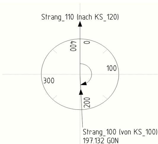
Winkel werden als Differenzwinkel zwischen den einzelnen Anschlüssen angezeigt
