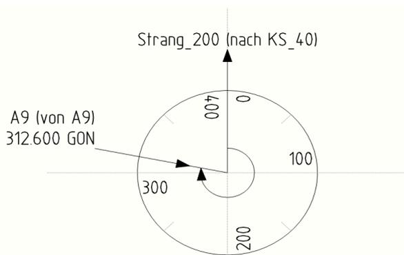
Winkel werden als Differenzwinkel zwischen den einzelnen Anschlüssen angezeigt
