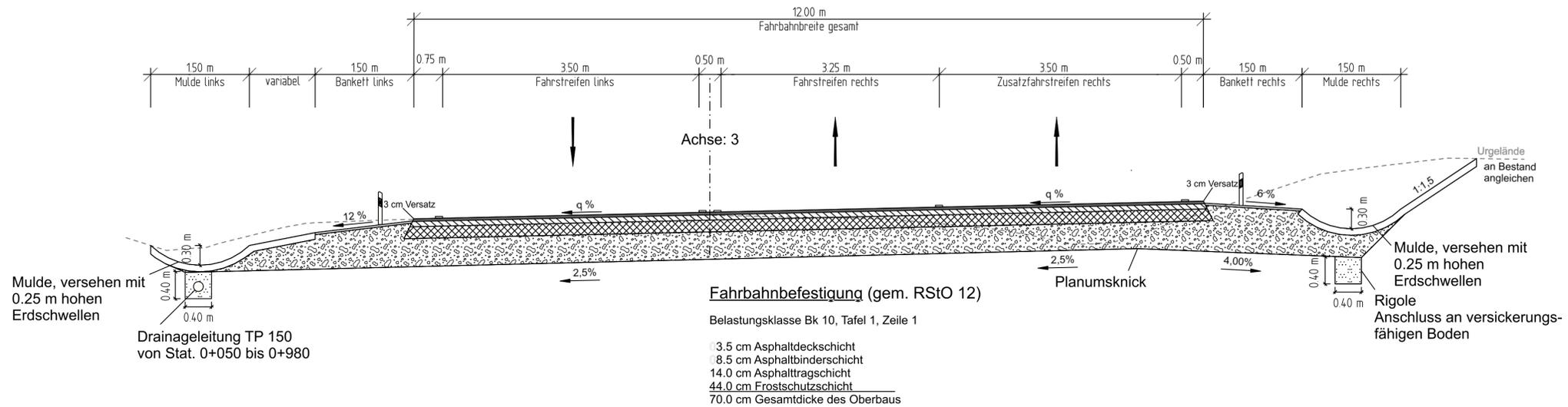
Regelquerschnitt RQ 11,5+ Mulde links
