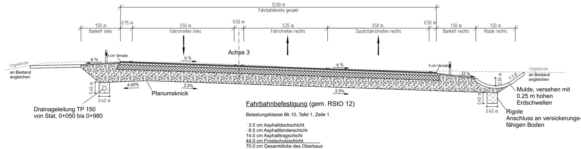
Regelquerschnitt RQ 11,5+ Mulde beidseitig
