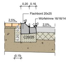
**Detail 2: Flachbord 30x25 mit verstärkter Rückenstütze**
