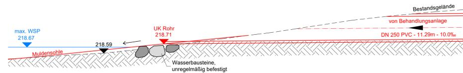
Detail: Auslauf zur Mulde, Schnitt (M: 1:20)
