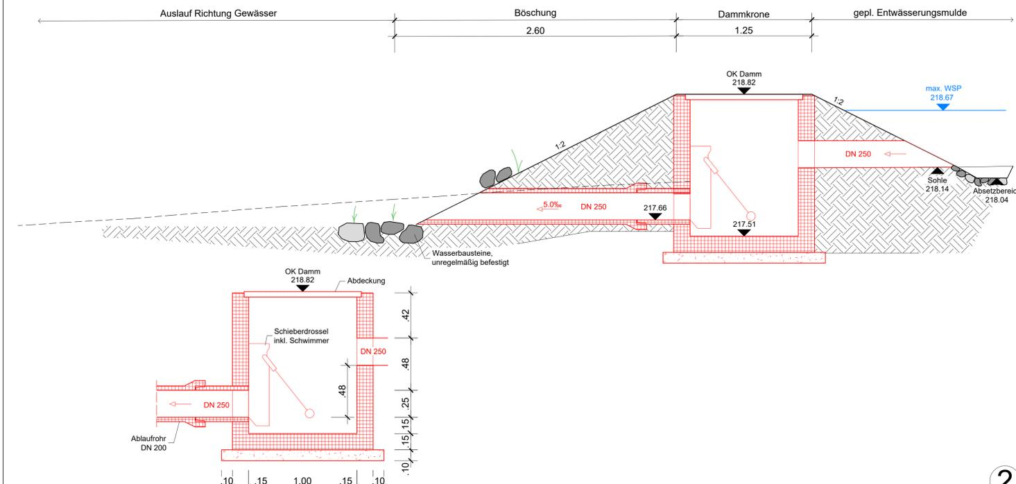
Detail: Drosselbauwerk, Schnitt 1 (M: 1:20)
