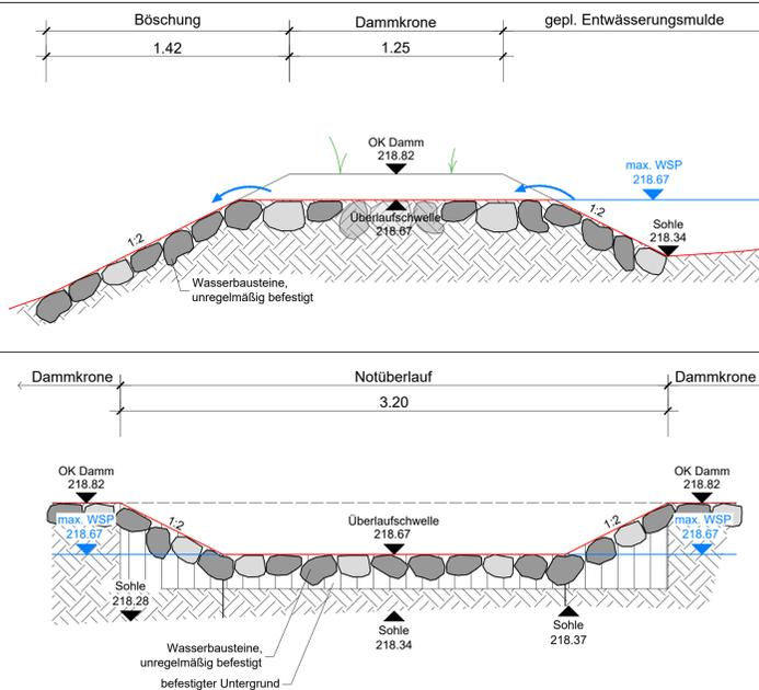
Detail: Notüberlauf, Schnitt 1 (M: 1:20)
