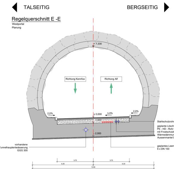
**REGELQUERSCHNITTE A - A bis E - E DIANA - TUNNEL**
